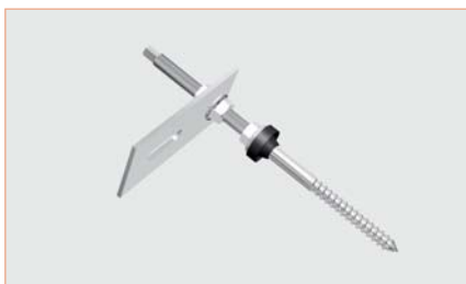
Stockschrauben-Set Art.Nr. GPV-01-0007-00 bis -04 Material: Edelstahl 1.4301. Dichtung: EPDM-Gummi.
